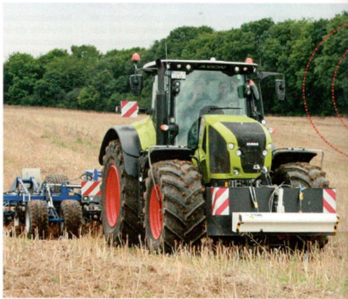
Der Scanner vor dem Frontballast steuert hier in Echtzeit die Arbeitstiefe des Köckerling Vector 620.
